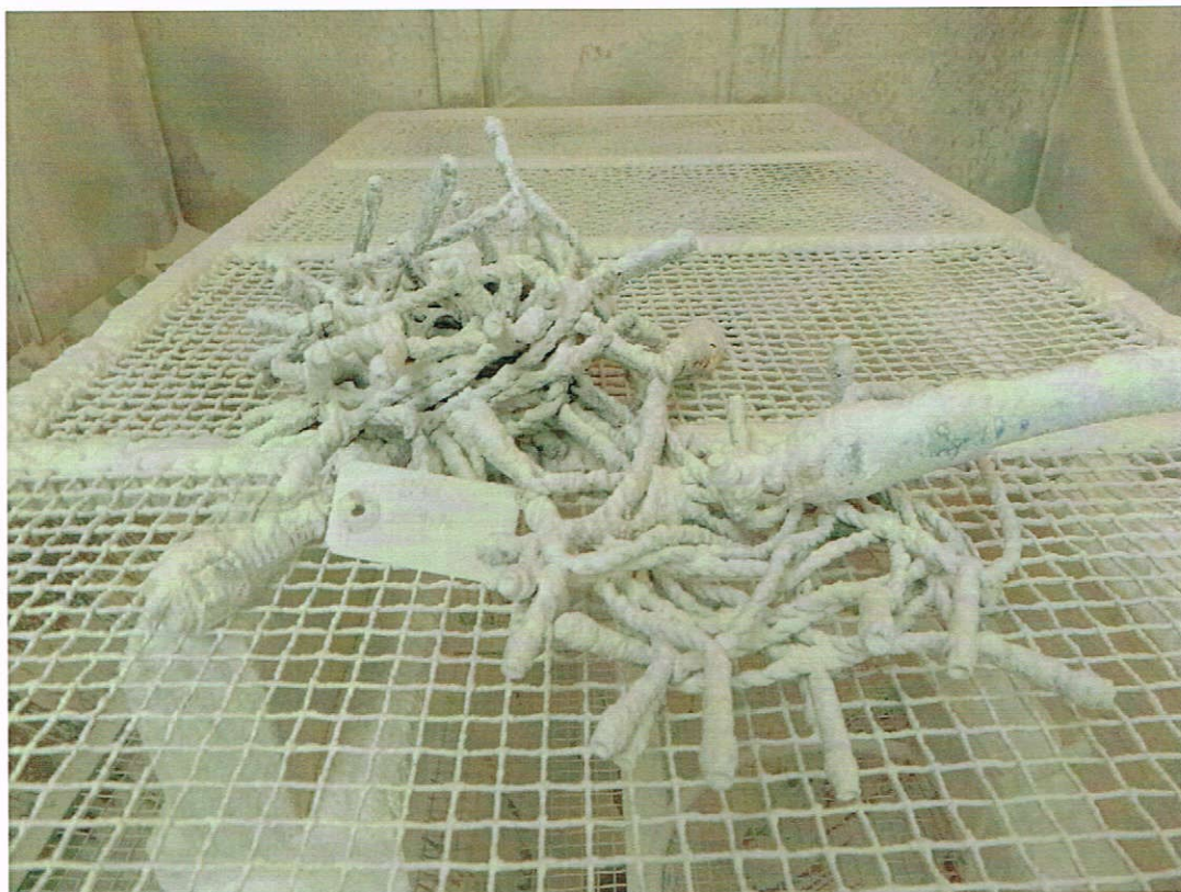
写真3 IP6X試験の様子 (2芯LEDストリングライト)
